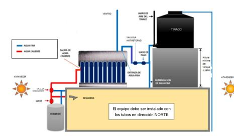
Efectuar las conexiones de agua por su instalador o empresa especializada
